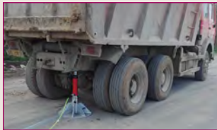
Vérification du support (portance nimum et nivellement)
