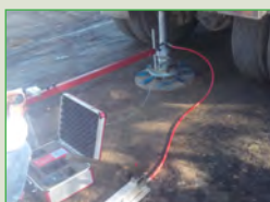
Vérification de la portance in-situ
