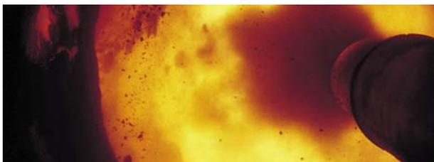
Le co-processing, ou co-incinération, consiste à utiliser des combustibles alternatifs et recycler les matières de substitution dans les fours des cimenteries. Le processus de valorisation des déchets s'opère en simultané du procédé industriel (production du clinker et du ciment) et à l'aide du même outil (les fours de cimenterie). La valorisation est totale: l'énergie et la fraction minérale des déchets sont récupérées.
