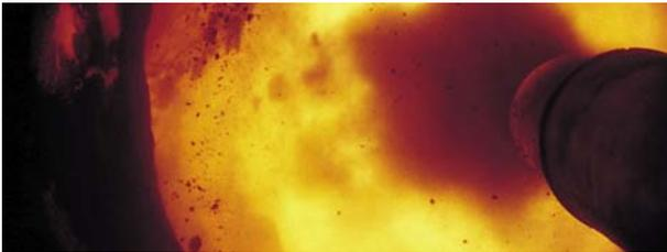
Le co-processing, ou co-incinération, consiste à utiliser des combustibles alternatifs et recycler les matières de substitution dans les fours des cimenteries. Le processus de valorisation des déchets s'opère en simultané du procédé industriel (production du clinker et du ciment) et à l'aide du même outil (les fours de cimenterie). La valorisation est totale: l'énergie et la fraction minérale des déchets sont récupérées.
